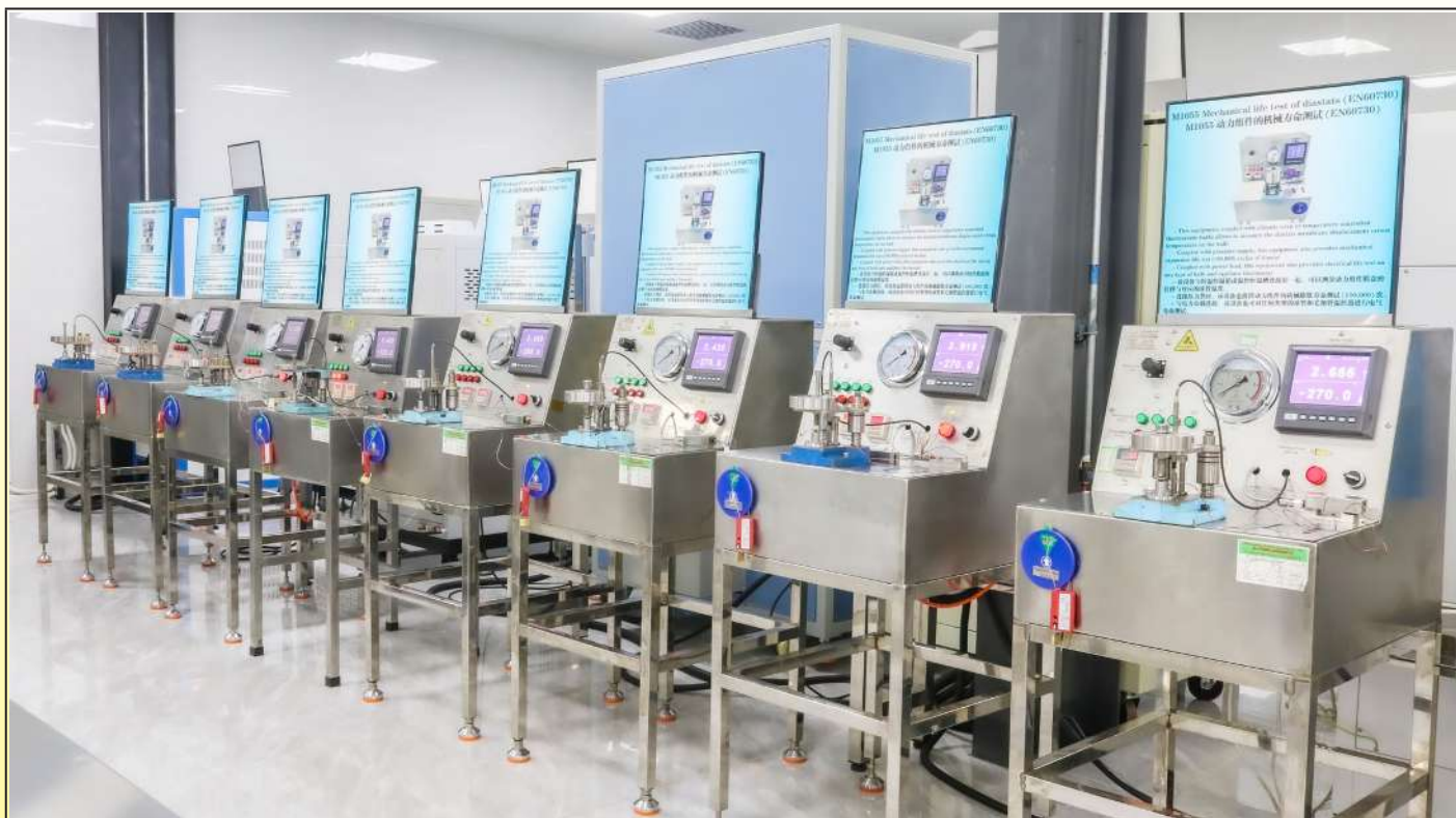
Batterie d'appareils de test de durée de vie de trains thermostatiques. Chaque appareil est équipé d'un enregistreur de paramètres et de nombre de cycles. (Laboratoire Ultimheat).
